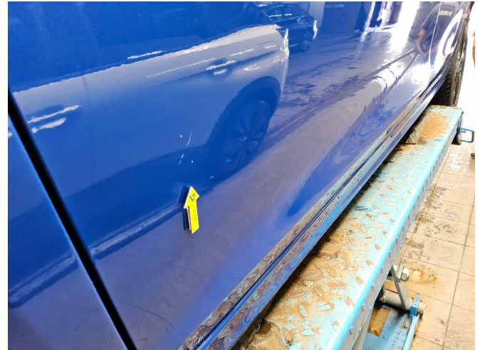
Bild 2: Außen, Tür vorne links, Kratzer , smart repair
