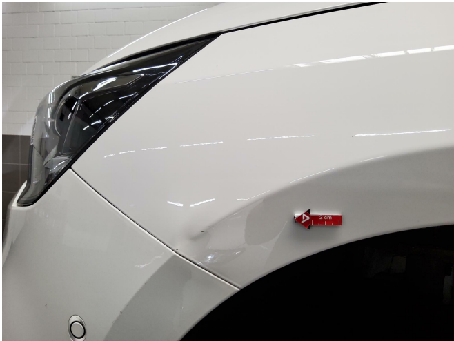
Bild 4: Außen, Kotflügel vorne links, Delle, Kratzer , smart repair
