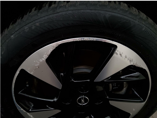
Bild 3: Außen, 1 Leichtmetallfelge - Freitext, beschädigt , instandsetzen
