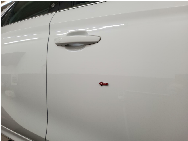
Bild 2: Außen, Tür vorne rechts, Delle , smart repair
