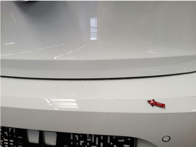
Bild 1: Außen, Stoßfänger hinten, Kratzer , smart repair
