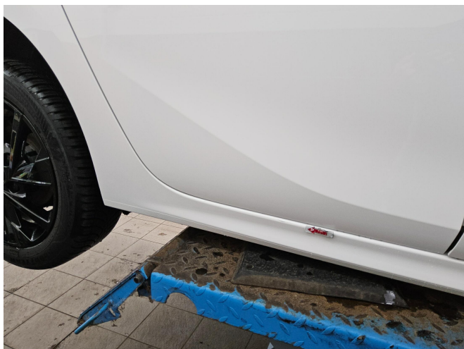
Bild 1: Außen, Seitenschweller rechts, Kratzer , smart repair
